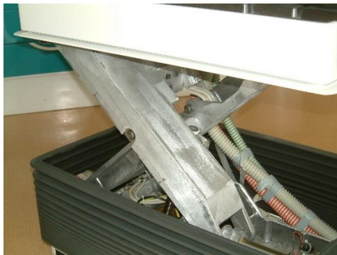
Figure 3 – Photo du système d'élévation (soufflet de protection détaché)
