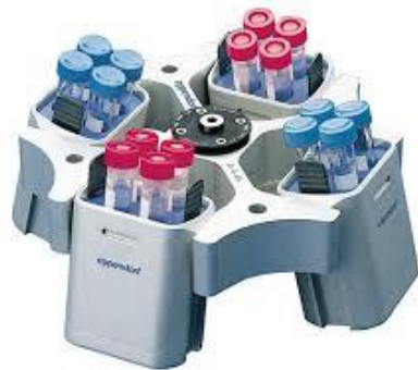
Figure 1.2 – Rotor avec paniers oscillants
