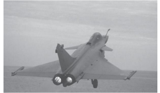
Figure 1- Avion de combat Rafale propulsé par deux moteurs Snecma M88
