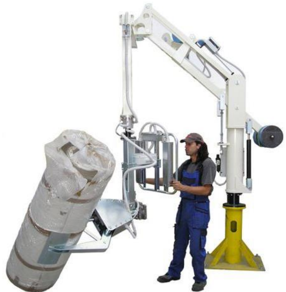
Figure 1 – Manipulateur auto-équilibré équipé d'une pince
